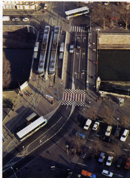
Saint-Denis: traversée piétonne renforcée entre la station tramway et la gare SNCF
