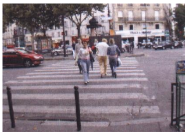
Photo 5 : Potelets sur traversée
