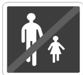
B55. Sortie d'aire piétonne
