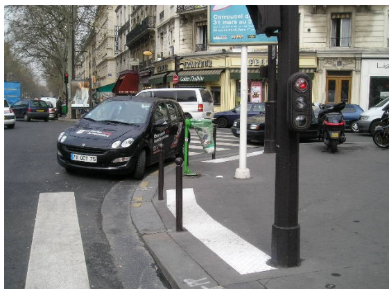
Photo 7 : Obstruction complète des itinéraires PMR par des stationnements illicites (autos, motos) et par des objets fixes (poubelles, poteaux, publicité)
